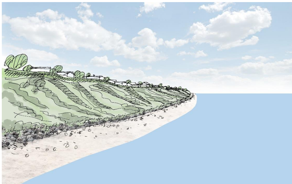
Figur 2.1: Overordnede kysttekniske princip for kystbeskyttelsesprojektet Nordkystens Fremtid, som omfatter strandfodring med sand, grus og ral (Kilde: Kystteknisk Skitseprojekt, 2016).
