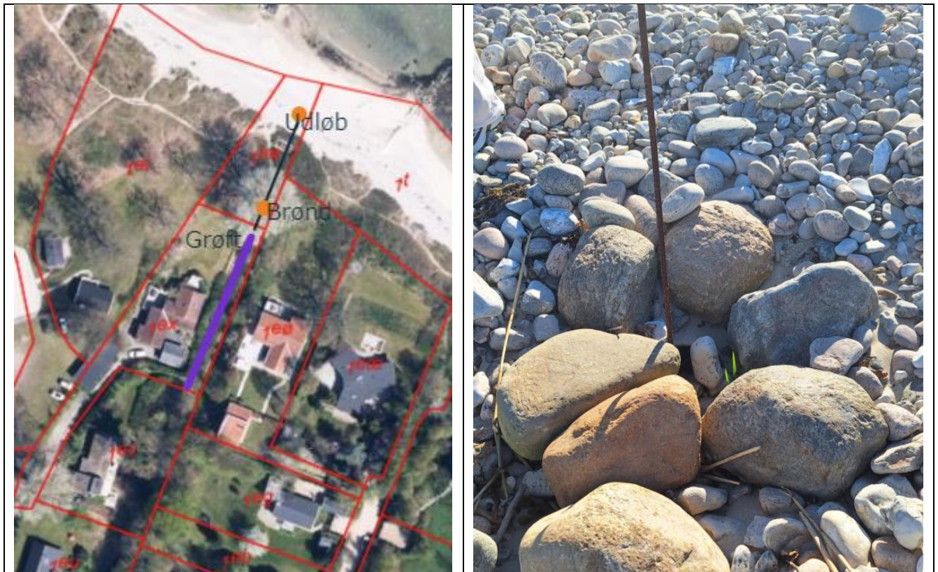
Figur 1: Forløb af grøft og rørlagt vandløb (venstre) og udløbet på stranden (højre). Luftfoto: Arealinformation.
