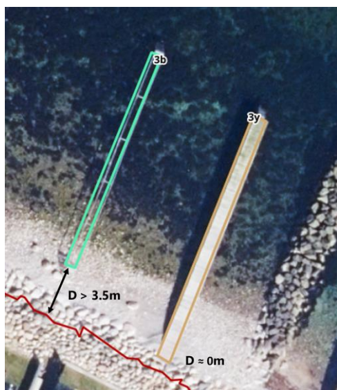
Figur 5: Eksempel på to badebroer, hvor der for badebroen til venstre er tilstrækkelig afstand mellem skråningsbeskyttelse og badebro til at maskiner kan passere. Det er for denne badebro antaget at der kan køres på selve skråningsbeskyttelse. For badebroen til højre vil der være behov for at fjerne dele af badebroen i anlægsfasen. Rød linje angiver strandfodringskoten.
